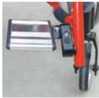
Predellino regolabile in inclinazione con blocchetto di regolazione della posizione Tilt adjustable foot-plate with adjustable position device
