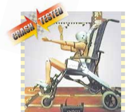
CLIP 1-2-3 ha superado el CRASH TEST en conformidad con las normas ISO 7176-19 y ANSI RESNA WC/19
