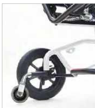
932 Antivuelcos solo para B30 (de serie en modelo B60).
