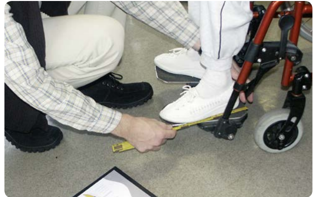
Medición exacta para el apoyo de piernas y pies Precise measurements for leg and foot-supports
